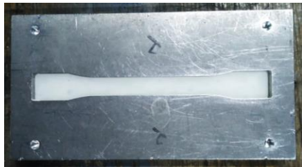
Figura 22. Molde de tensión vaciado con material
