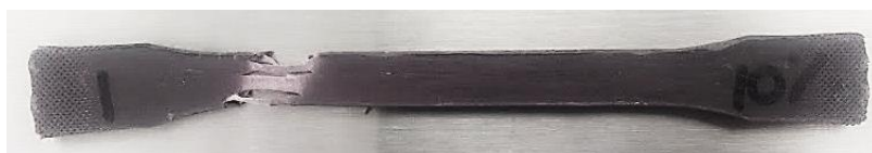
Figura 32. Probeta de tensión 90%PEBDR-10%wt Fe con cedencia dúctil
