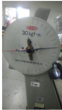
Figura 34. Máquina para el ensayo de impacto
